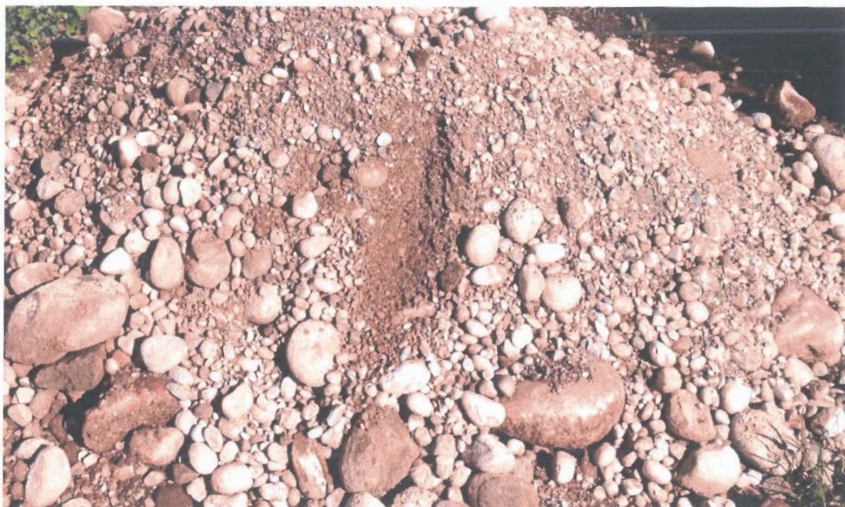
Vista dei materiali ghiaiosi estratti dalla trincea esplorativa
